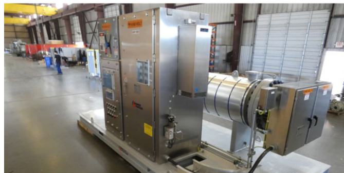
Bolaget Gaumer's banbrytande teknik med medelspänning (4160 V) för elektrisk uppvärmning av fjärrvärmepannor är en idealisk lösning för snabb uppstart, tyst drift, noll utsläpp och nästan 100% termisk effektivitet. Den bidrar till att minska det industriella koldioxidavtrycket, vilket är i linje med globala hållbarhetsmål.
